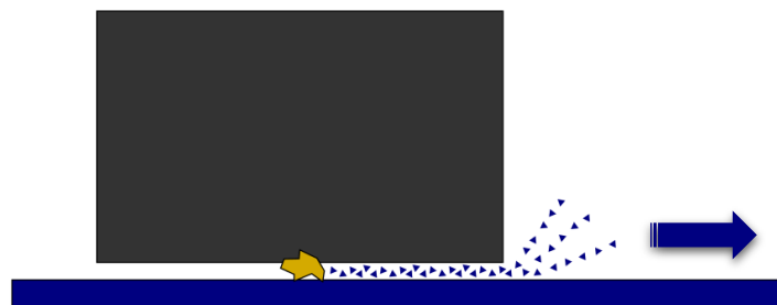
Caso 1: con biseles blandos o poco uniformes el mineral se tiende a quedar atrapado, pudiendo gastar la correa.
